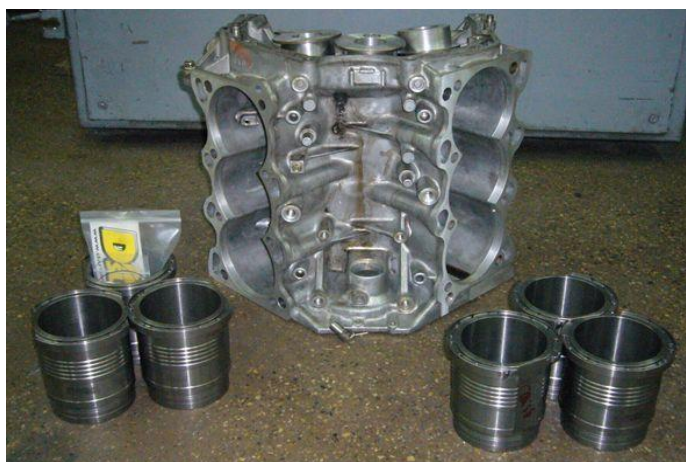
Рисунок 1.2. Чавунний блок циліндрів двигуна із знімними гільзами
