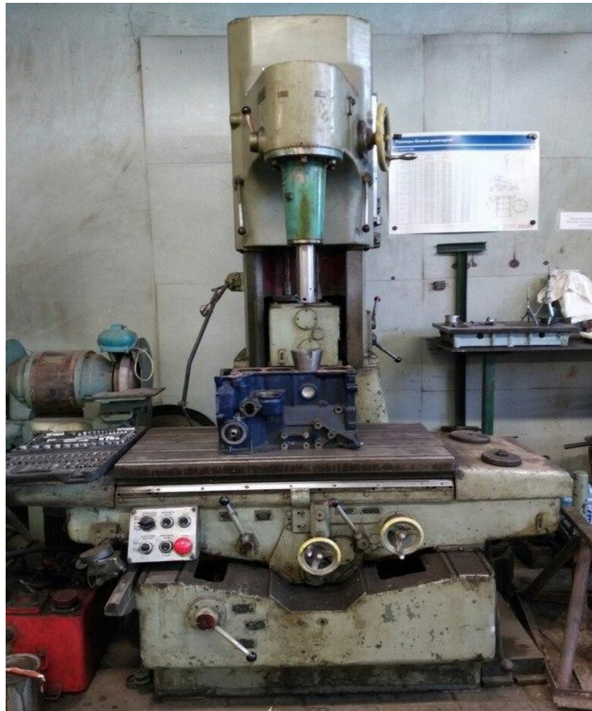
Рисунок 3.3 - Вертикально - розточувальний верстат 2Е78П
