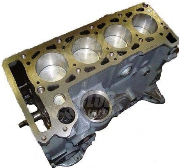
Рисунок 1.1. Монолітний чавунний блок циліндрів двигуна автомобіля Volkswagen passat b7
