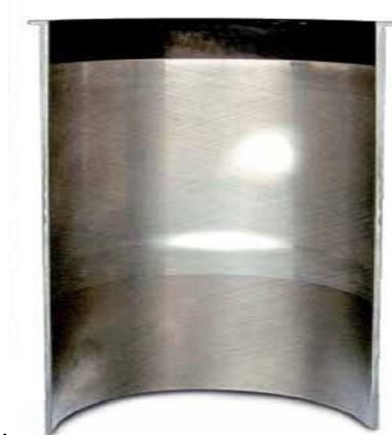
Рисунок 1.4 Характер нерівномірного зношування робочої поверхні гільзи циліндра
