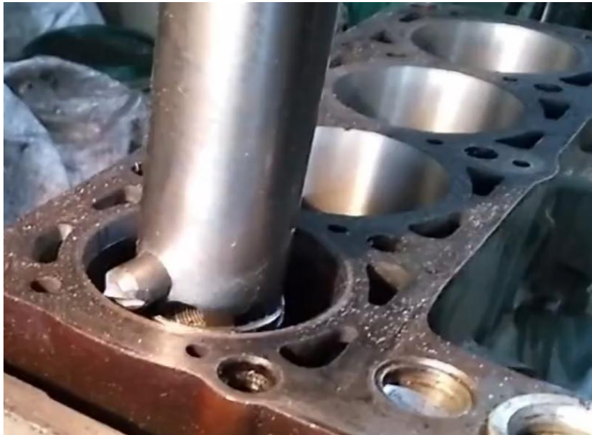
Рисунок 2.4 - Встановлення різця в робочу зону для процесу розточування
