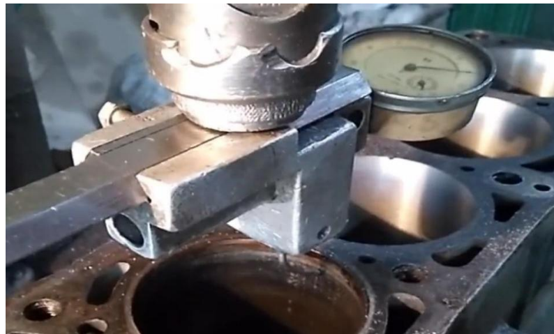
Рисунок 2.3 - Процес центрування блоків циліндра двигуна
