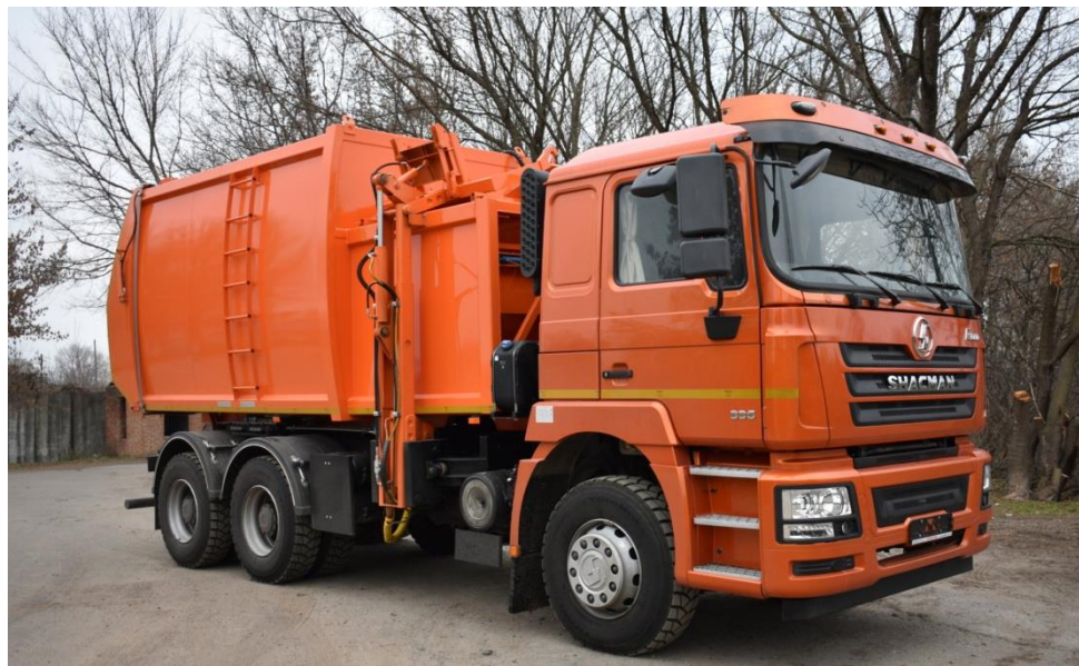
Рисунок 1.3 – Смітєвоз із боковим завантаженням
