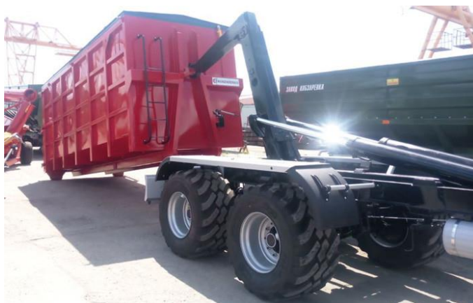
Рисунок 2.3 – Загальний вигляд причепа-мультиліфта
