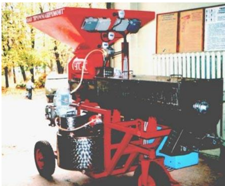
Рисунок 1.12 – Установка для передпосівного протруювання насіння УПС-10
