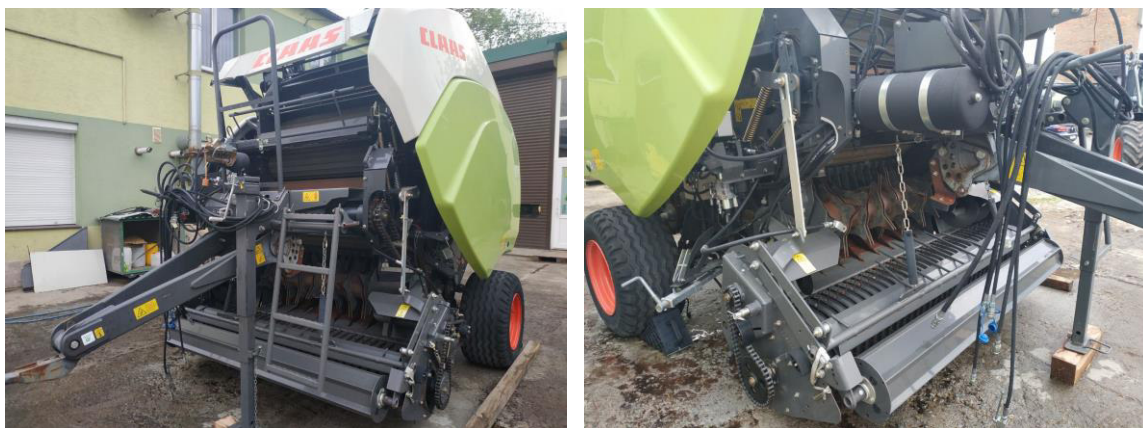
Рисунок 1.6 – Конструкція прес-підбирача рулонного від фірми «Claas»
