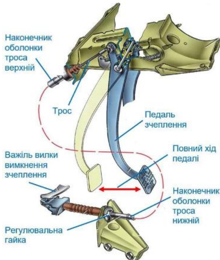
Рисунок 7.1 – Регулювання зчеплення з механічним приводом
