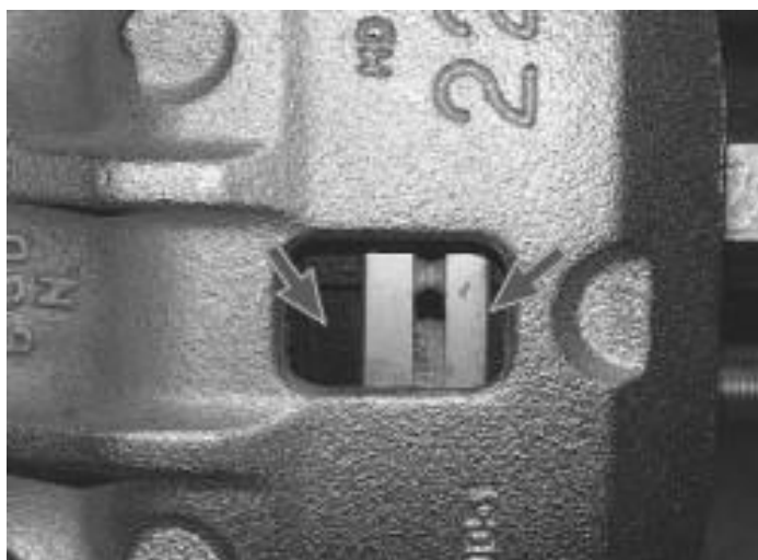
Рисунок 2.13 – Отвір в супорті для перевірки товщини фрикційних накладок гальмівних колодок
