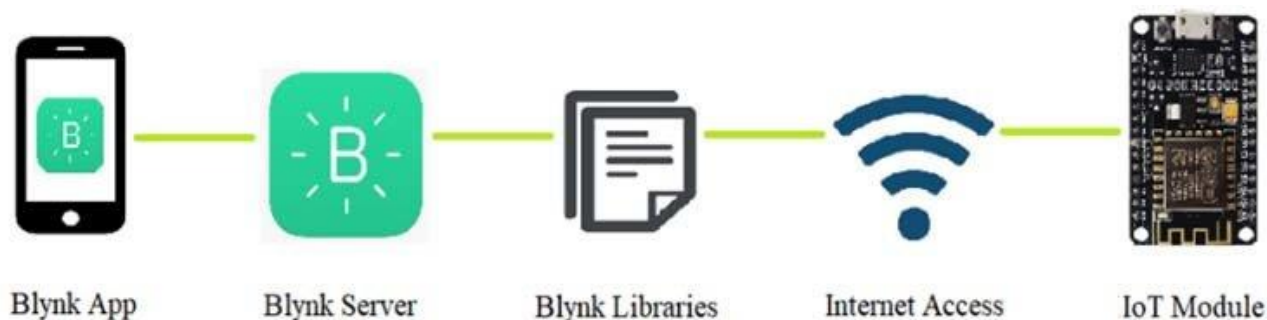
Рисунок 3.7 – Архітектура IoT платформи Blynk
