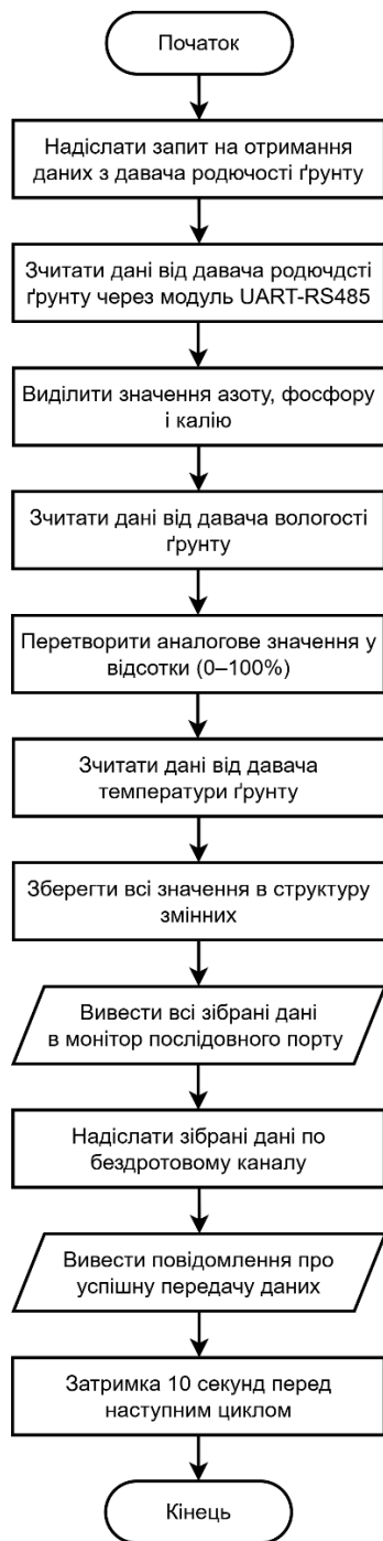
Рисунок 3.1 – Блок-схеми алгоритмів роботи циклічних підпрограм у системі моніторингу родючості ґрунту: а) сенсорного модуля на основі Arduino Nano; б) пристрою для передавання інформації в хмарну платформу на базі ESP32.
