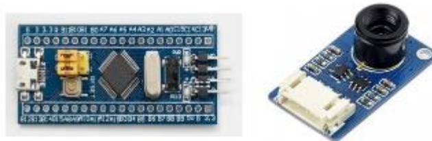
Рисунок 1.6 – Мікроконтролер STM32F103C8T6 та тепловізійна камера MLX90640
