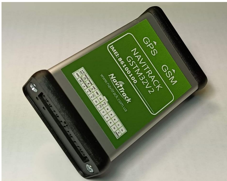
Рисунок 1.2 – Пристрій для контролю переміщення транспортних засобів «Navitrack GSTM32V2»
