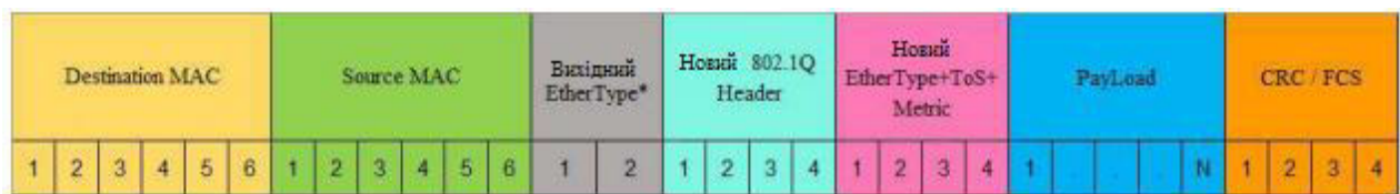
Рисунок 2.3 – Формат Ethernet кадру для роботи протоколу
