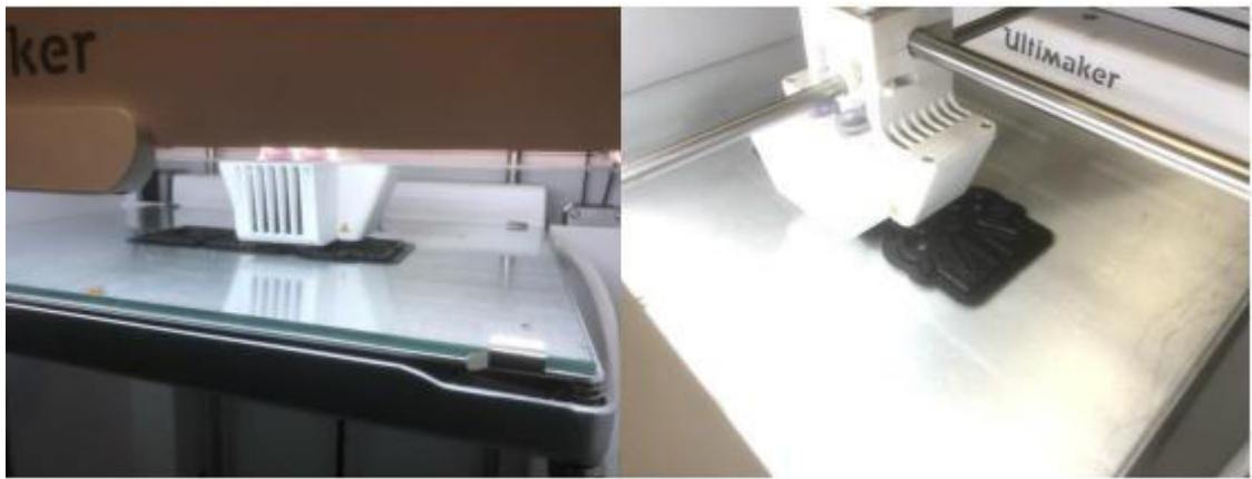
Рисунок 2.6 – Процес друку деталей на 3D- принтері
