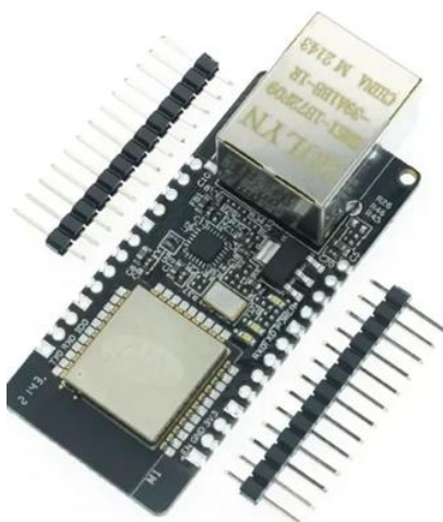
Рисунок 2.2 – Комунікативний шлюз WT32-ETH01 на базі ESP32
