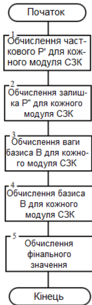
Рисунок 1.1 – Блок-схема алгоритму переведення числа із СЗК до ПСЧ
