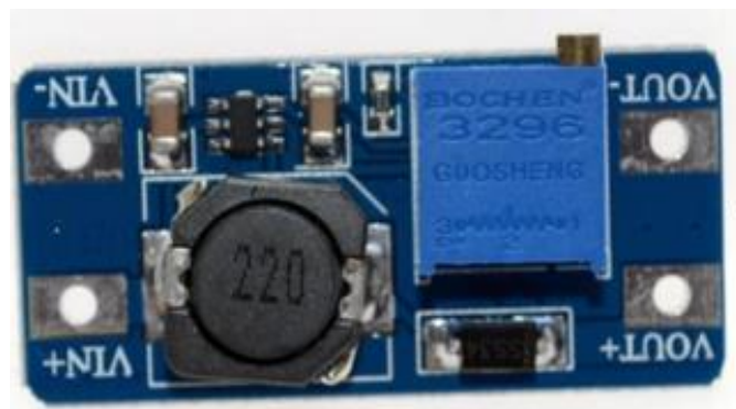
Рисунок 2.9 – Модуль підвищувача напруги MT3608
