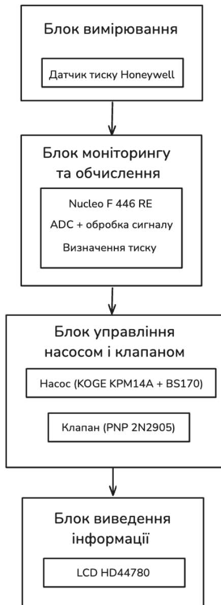
Рисунок 2.2 – Структурна схема системи вимірювання артеріального тиску й пульсу
