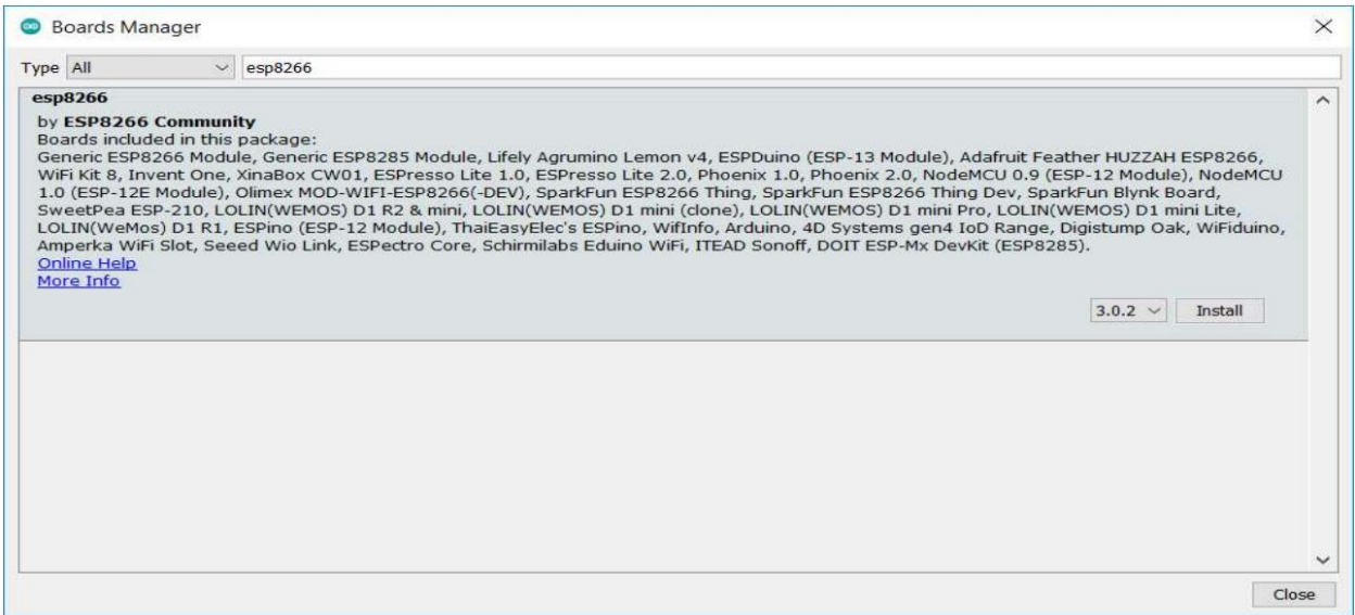
Рисунок 3.9 – Процес встановлення модуля в Arduino IDE для роботи з платформами, які працюють на базі мікроконтролера ESP8266
