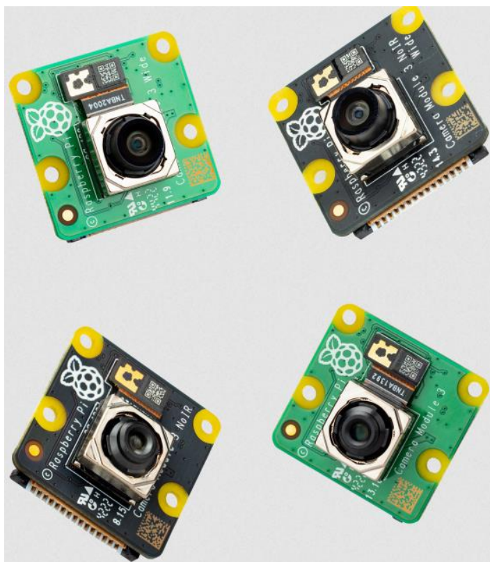
Рисунок 2.9 – Зовнішній вигляд Raspberry Pi Camera Module v3
