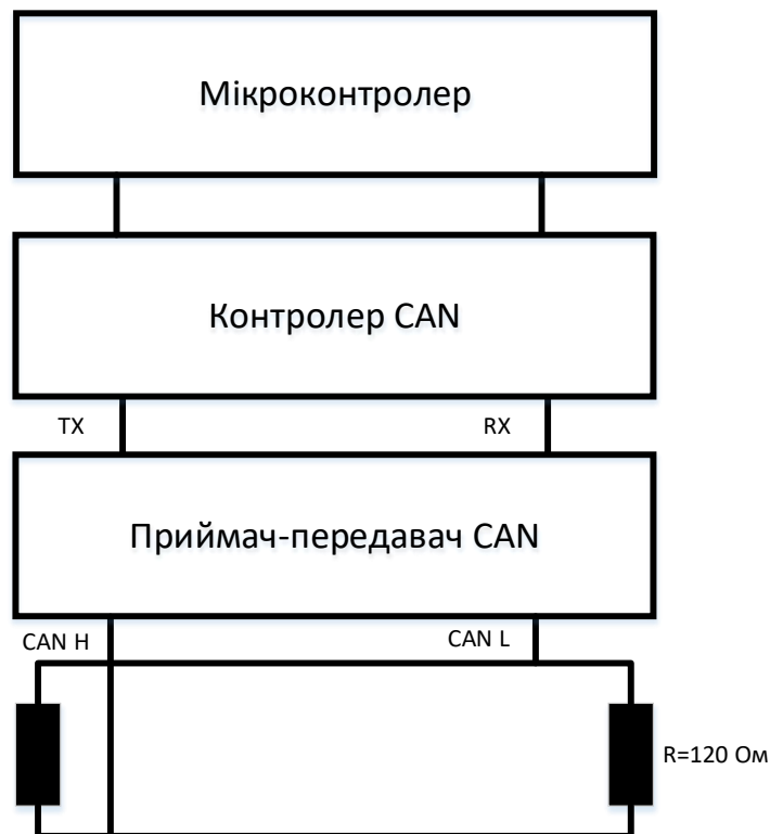
Рисунок 1.1 — Типова структура CAN-вузла
