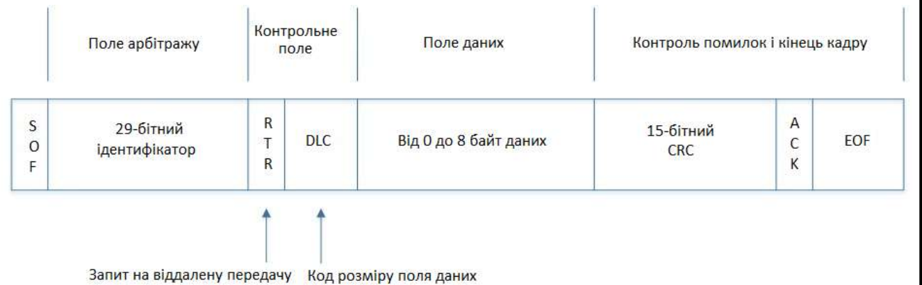
Рисунок 1.3 – Формат CAN-повідомлення
