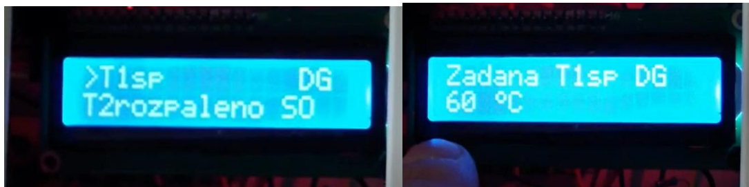
Рисунок 3.11 – Перехід в налаштування режиму розпалювання і налаштування режиму температури на виході з каміна
