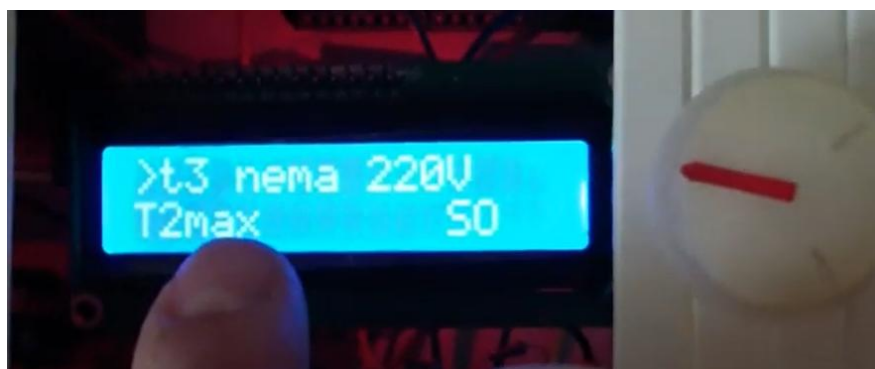
Рисунок 3.14 – Перехід в режим очікування коли відсутнє 220В
