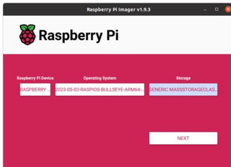
Рисунок 3.2 – Вибір системи для прошивки Raspberry Pi CM4
