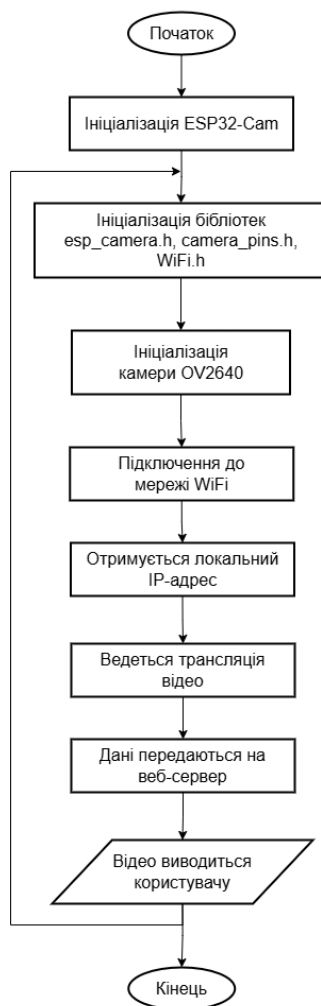
Рисунок 2.5 - Алгоритм роботи модуля ESP32-CAM
