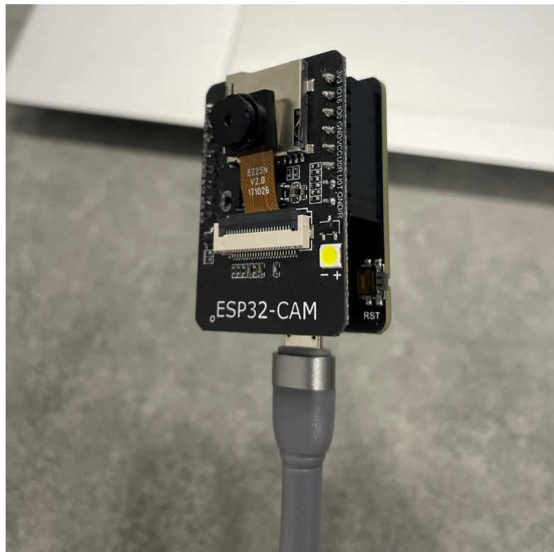
Рисунок 3.4 – Плата ESP32-CAM з'єднана з ESP32-CAM-MB
