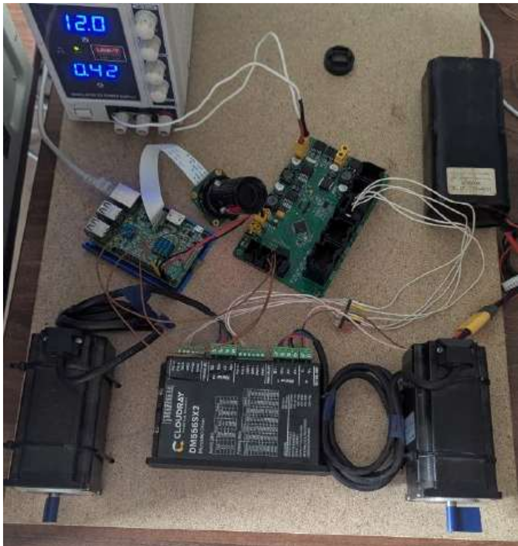
Рисунок 3.14 – Вигляд тестового стенда КС керування стабілізаційною платформою для наземної турелі
