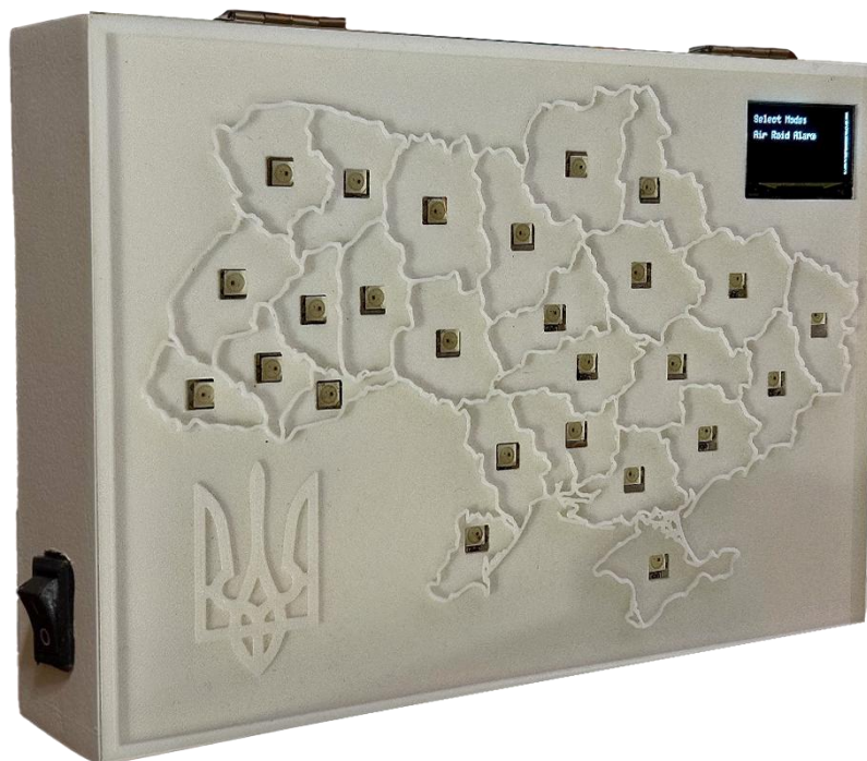
Рисунок 3.15 – Прототип комп'ютерної системи “Портативна карта України” в корпусі
