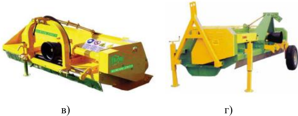
Рисунок 1.5 – Роторні подрібнювачі з горизонтальною віссю обертання ротора: а – причіпний ПП-2,0; б – начіпний ПН-2,0; в – начіпний Kornik Z902; г – начіпний з поздовжньою віссю транспортування
