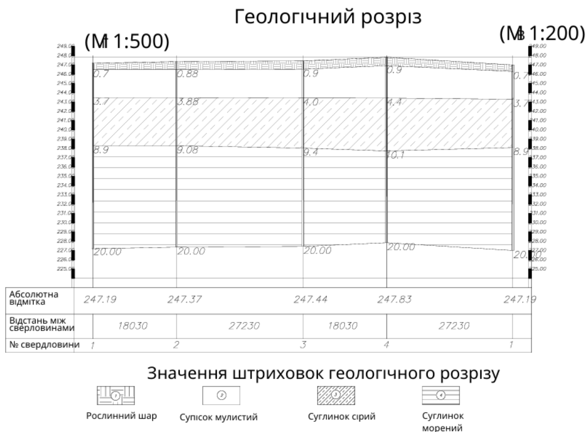
Рисунок 3.2 – Інженерно-геологічний розріз ділянки будівництва
