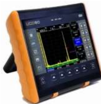
Рисунок 2.7 – Ультразвуковий дефектоскоп УСД-60 [9]
