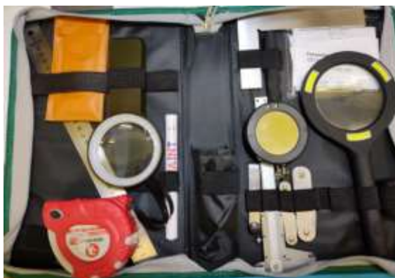
Рисунок 2.8 – Набір інструментів візуально-вимірювального контролю ВІК-1 [11]
