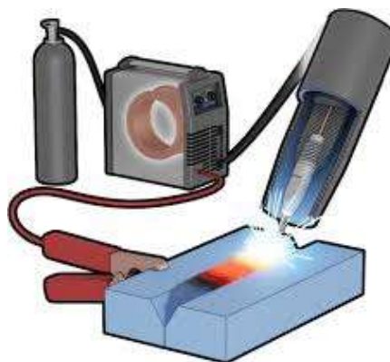
Рисунок 2.1 - Схема напівавтоматичного зварювання в захисних газах
