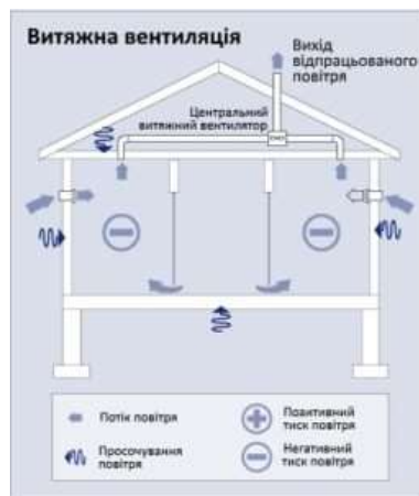
Рисунок 5.1 – Схема витяжної вентиляції
