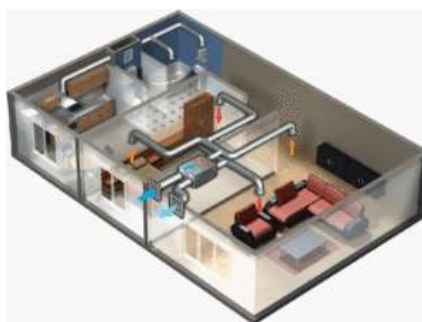
Рисунок 5.3 – Схема припливно-витяжної вентиляції
