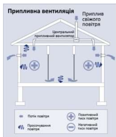
Рисунок 5.2 – Схема припливної вентиляції
