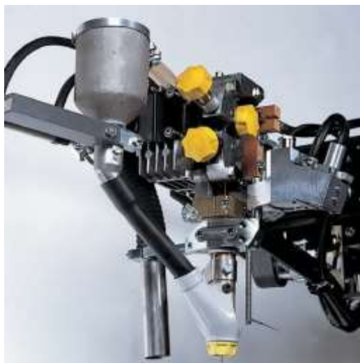
Рисунок 2.3 – Зварювальна головка системи А6 S Compact 300 [6]
