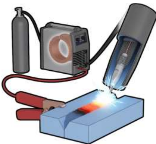
Рисунок 2.1 – Схема способу MIG зварювання
