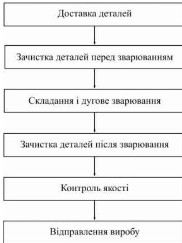
Рисунок 2.5 - Схема технологічного процесу виготовлення розширювача парогазової суміші
