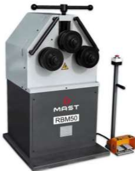
Рисунок 2.4 – Електромеханічний згинальний верстат MAST RBM50 [9]
