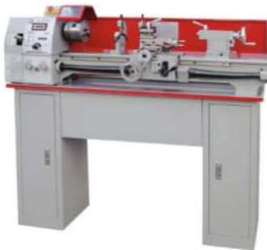
Рисунок 2.6 – Токарний верстат Holzmann ED 750FDQ [11]
