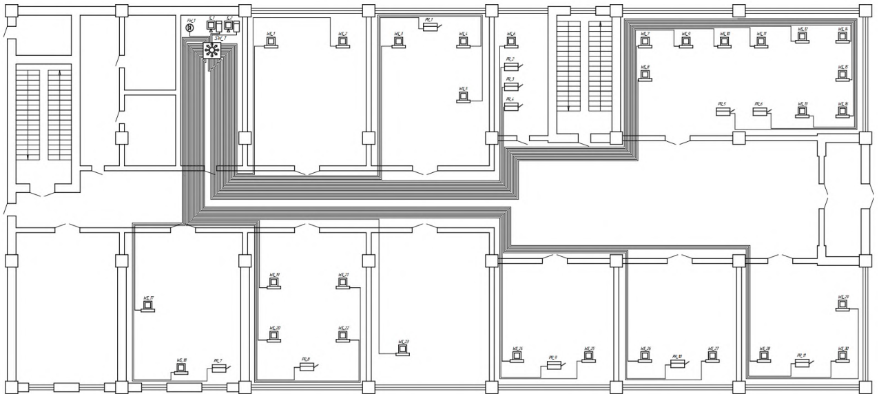
Рисунок 2.8 – Фізична топологія мережі
