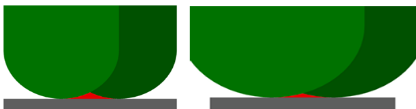
Рисунок 1.5 - Висота гребінця з меншим і більшим діаметром інструменту [22]
