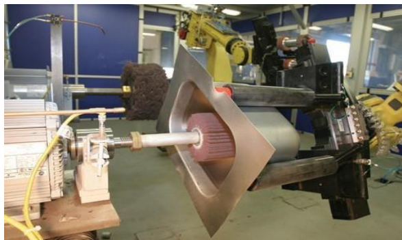
Рисунок 1.8 - Процес полірування роботом [24]
