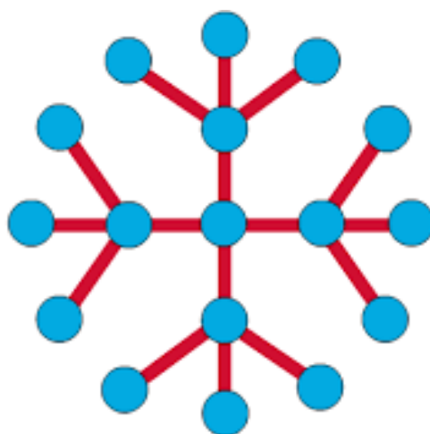
Рисунок 2.2 – Логічна топологія типу «розширена зірка»
