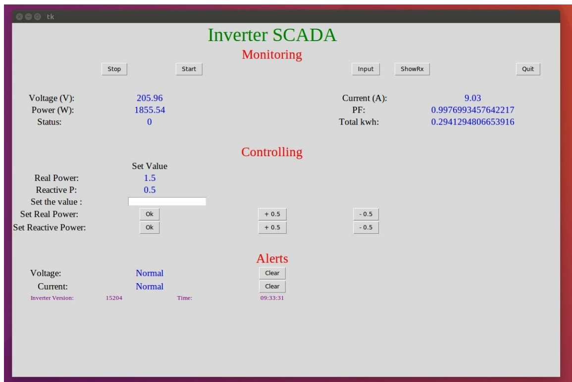
Рисунок 2.17 - Графічний інтерфейс для SCADA інвертора, розроблений на Python
