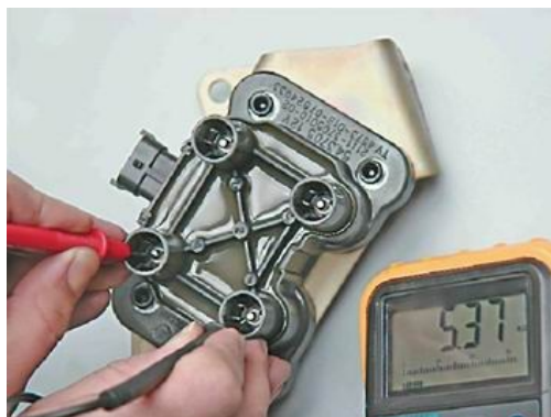
Рисунок 2.9 – Вимірювання опору вторинних обмоток
