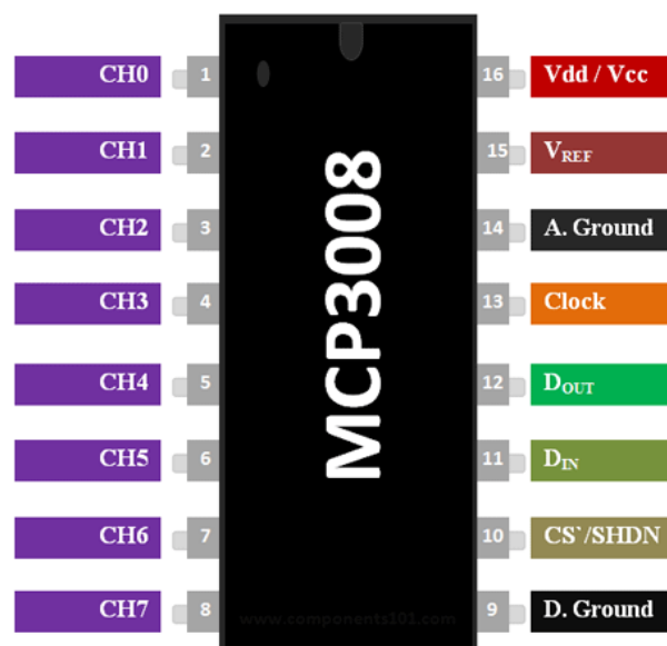
Рисунок 2.7 Схема розташування виводів IC аналого-цифрового перетворювача MCP3008
