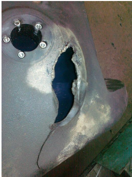
Рисунок 2.9 - Типове пошкодження паливного пластикового бака
