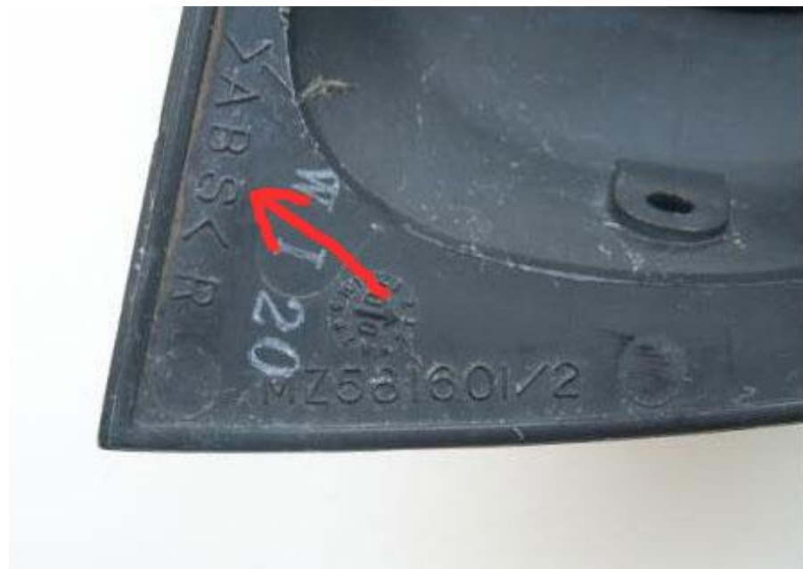
Рисунок 2.17 - Маркування пластику (ABS- акрілопетріловий бутадієн стерол)
