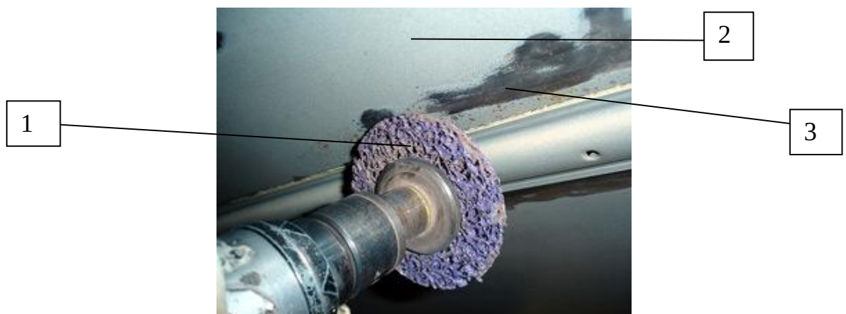
Рисунок – 2.8 Один із методів позбавлення корозії з поверхні деталі: 1-зачисний круг; 2-деталь; 3-корозія.
