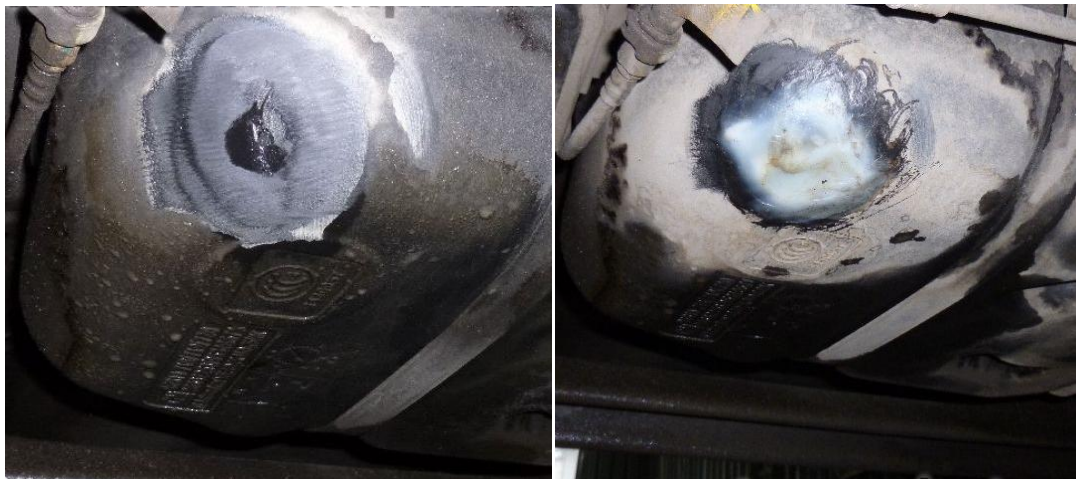
Рисунок 2.16 - Зразок ремонту пластикового бака на автомобілі: а - місце пошкодження підготовлене до ремонту, б - відремонтований бак.
