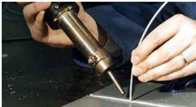
Рисунок 2.14 - Зварювання нагрітим газом
