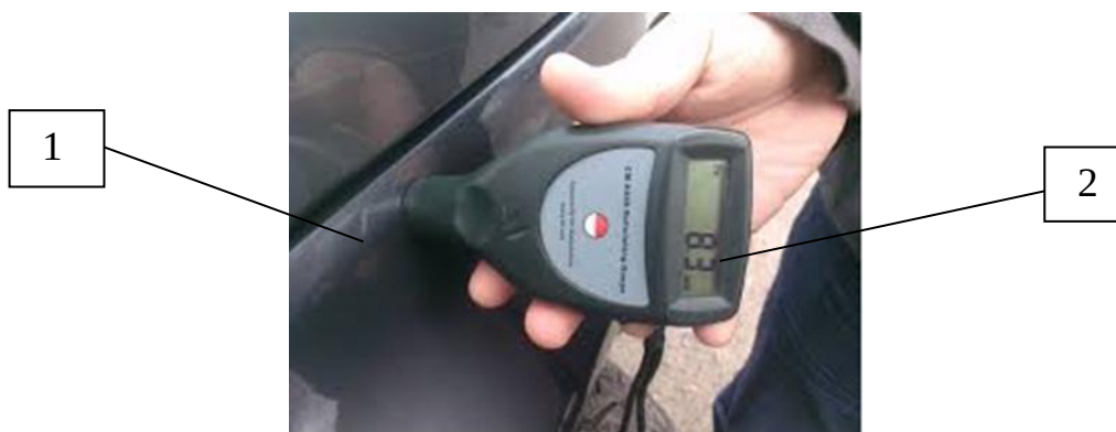
Рисунок 2.1 - Метод вимірювання товщини ЛФП:
