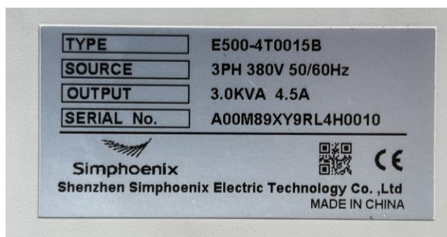
Рисунок 2.7 Паспортна табличка частотного перетворювача Simphoenix E500-4T0015(B)
