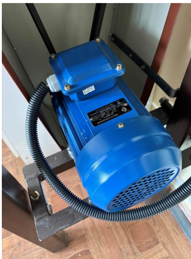
Рисунок 2.17 Конструктивне закріплення трифазного двигуна в системі приводу станду
