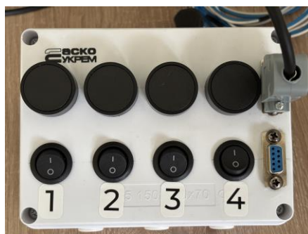
Рисунок 2.9 Блок кнопок фіксованої та нефіксованої дії для керування входами X1–X4 ЧП
