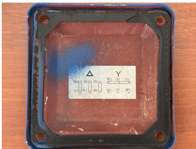
Рисунок 2.18 Схема з'єднання обмоток електродвигуна "зірка" та "трикутник" на кришці клемної коробки
