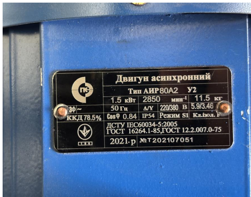
Рисунок 2.16 Паспортна табличка асинхронного електродвигуна
