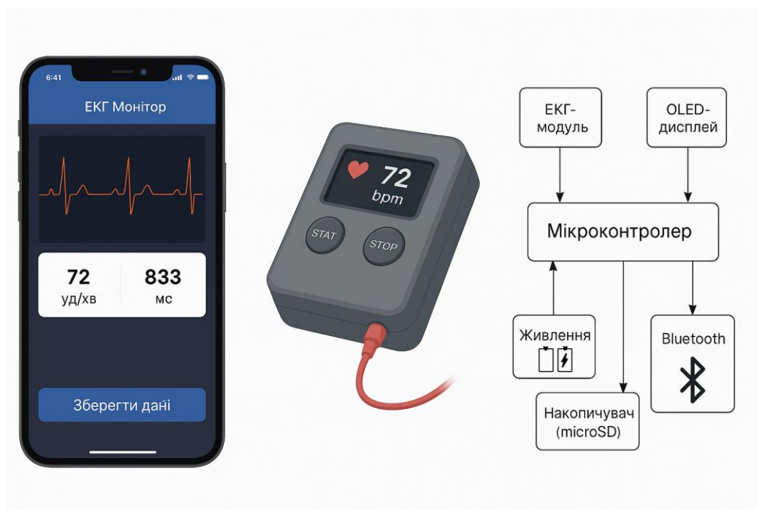
Рисунок 2.5 – Візуалізація інтерфейсу користувача, 3D моделі пристрою та загальна структурна схема з'єднань
