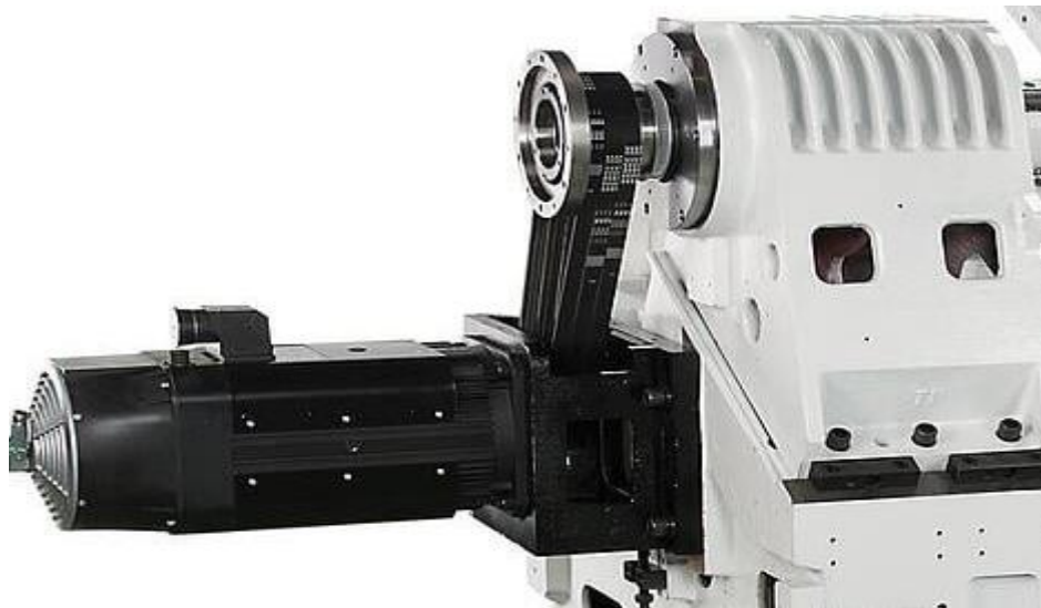
Рисунок 1.10 – Привід головного руху токарного верстата з ЧПК з пасовою передачею
