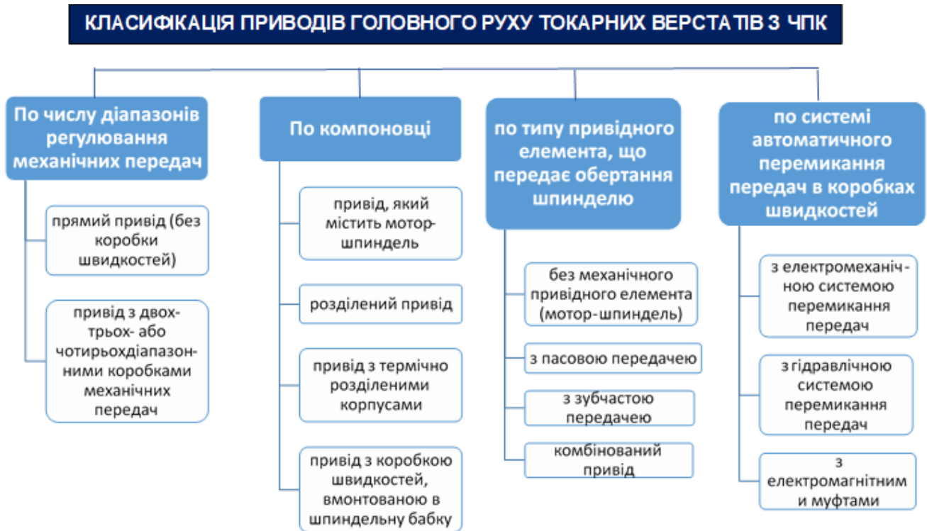
Рисунок 1.9 – Класифікація приводів головного руху токарних верстатів з ЧПК
