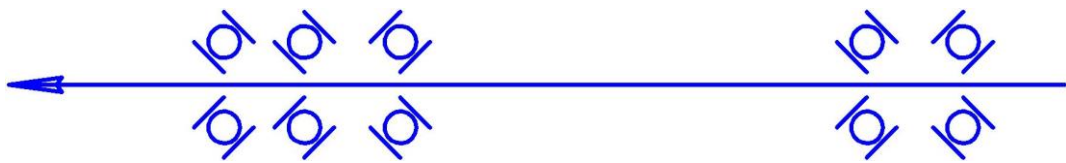
Рисунок 3.5 – Компоувальна схема шпиндельного вузла
