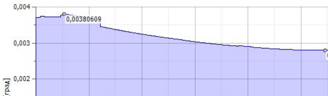
Рисунок 3.15 – Кут повороту осі шпинделя за результатами моделювання
