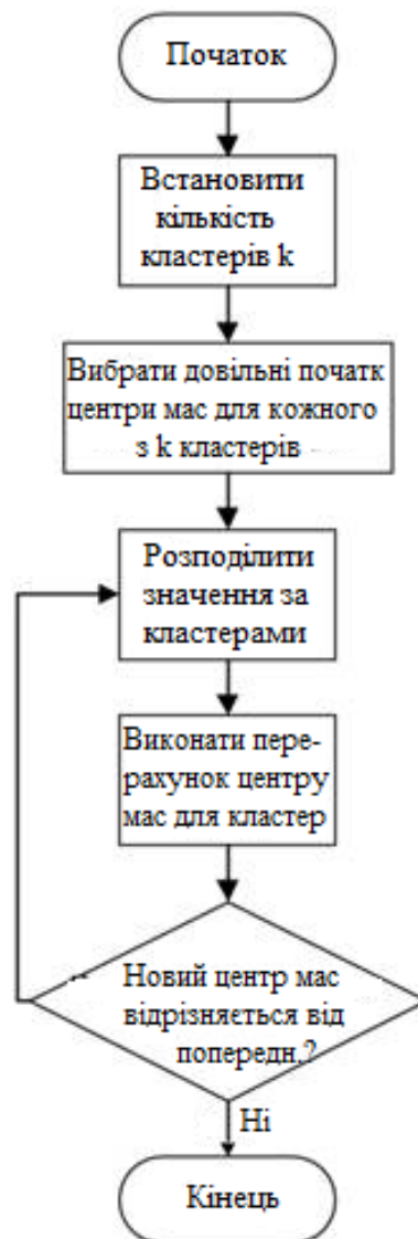
Рисунок 2.4 – Блок-схема алгоритму K-Means
