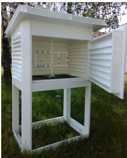
Рисунок 2.1 – Метеорологічна будка для вимірювання температури
