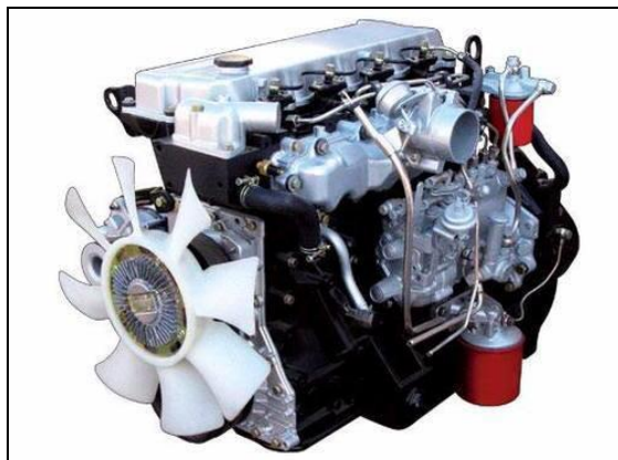
Рисунок 1.3 – Загальний вигляд двигуна Isuzu 4HG1
