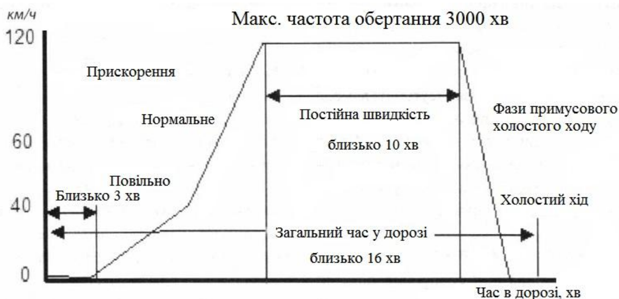
Рисунок 2.5 - Приклад циклу руху для досягнення готовності до перевірки
