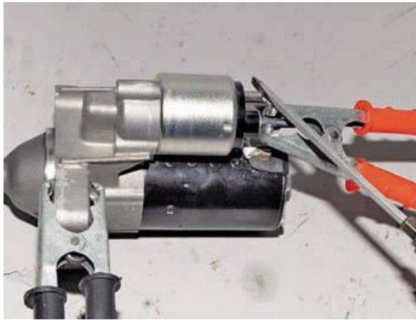
Рисунок 2.10 – Перевірка роботи здатності стартера
