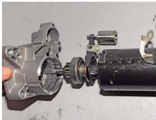
Рисунок 2.15 – Від'єднання передньої кришки
