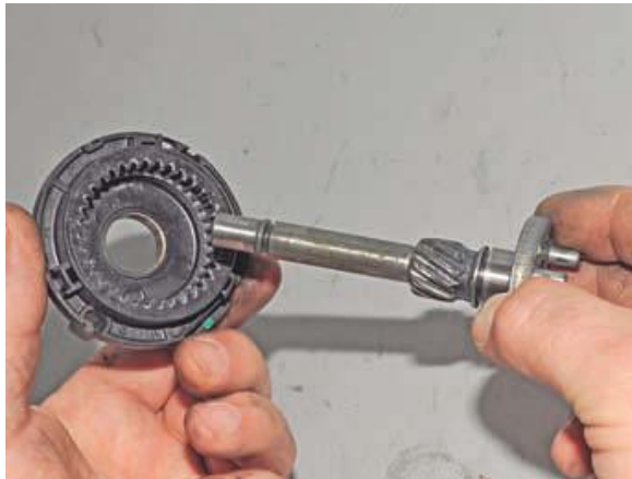
Рисунок 2.28 – Зняття коронної шестерні
