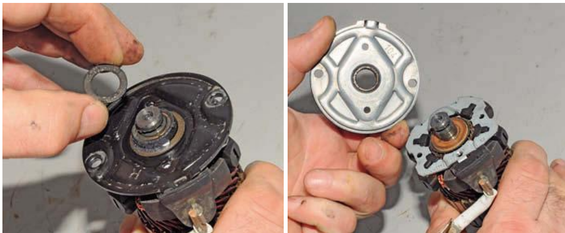
Рисунок 2.20 – Зняття задньої кришки стартера
