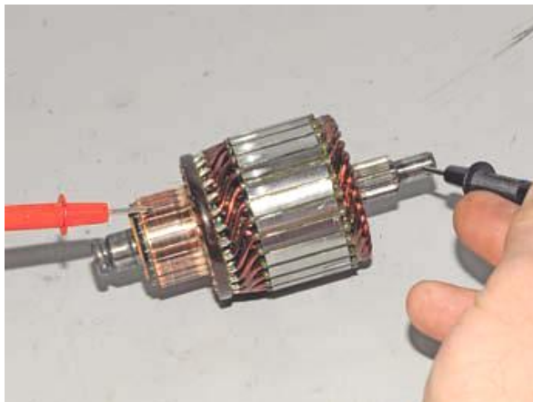
Рисунок 2.29 – Перевірка якоря омметром
