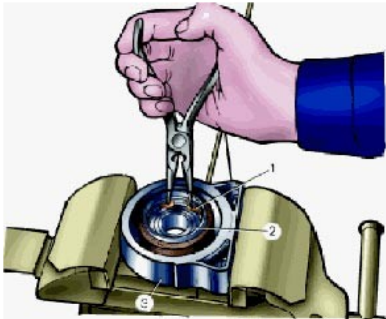
Рисунок 2.7 - Демонтаж стопорного кільця підшипника проміжної опори:
