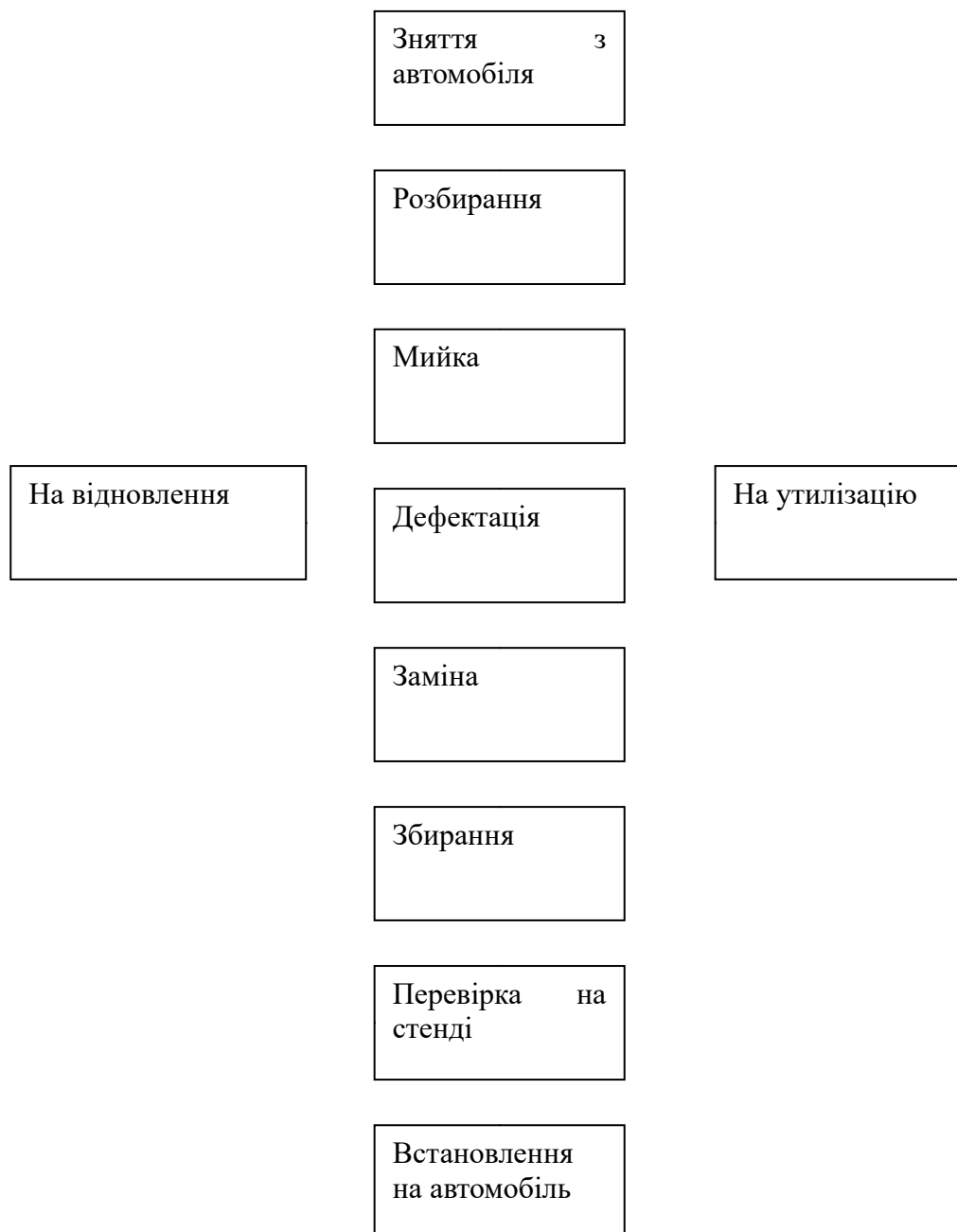
Рисунок 2.1 – Схема технологічного процесу у ремонтному відділенні
