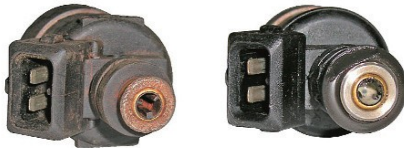
Рисунок 3.5 - Форсунки які пошкоджені і підлягають вибракуванню
